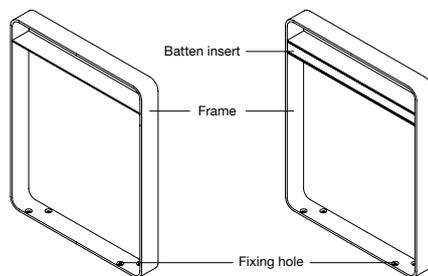
NO BATTEN INSERT WITH BATTEN INSERT
